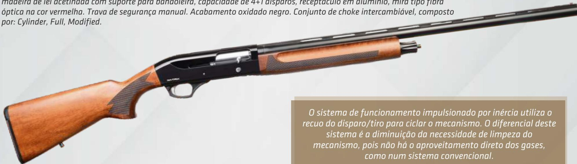
O sistema de funcionamento impulsionado por inércia utiliza o recuo do disparo/tiro para ciclar o mecanismo. O diferencial deste sistema é a diminuição da necessidade de limpeza do mecanismo, pois não há o aproveitamento direto dos gases, como num sistema convencional.
